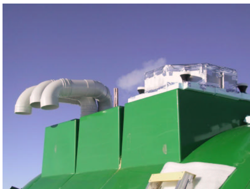
Fig. 1. The SODAR antenna installed on top of the AASTINO.
